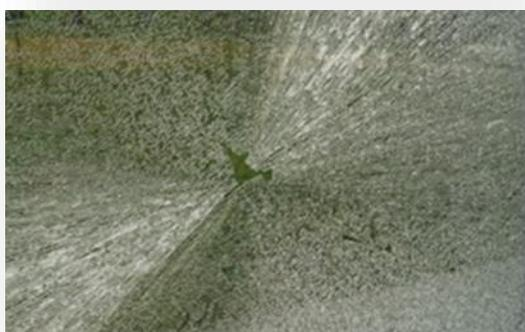
Rottura del vetro temperato per presenza di solfuro di nichel
